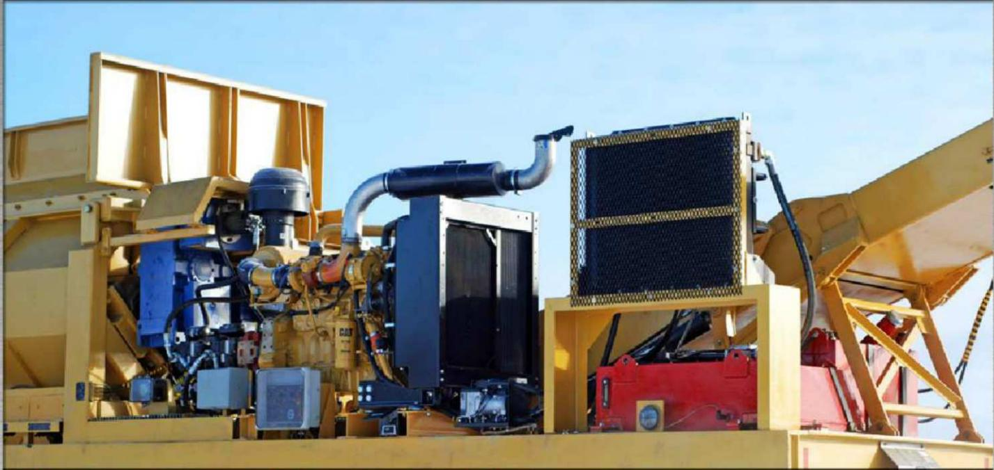
L'écorceur rotatif mobile à alimentation continue est composé d'un module de 20 ou 30 pieds de long à trois rotors. Chaque rotor est motorisé indépendamment par des moteurs hydrauliques couplés à des réducteurs de vitesse. Le système hydraulique est propulsé par un engin diesel CAT C9 (350 HP) ou C7 (300 HP). La vitesse des trois rotors peut être ajustée selon la production désirée.
