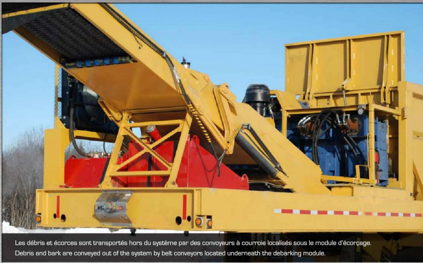
Les débris et écorces sont transportés hors du système par des convoyeurs à courroie localisés sous le module d'écorçage.
